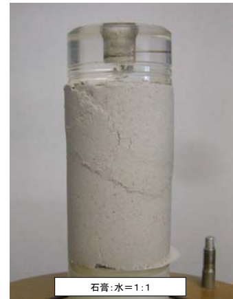
写真-1 せん断後の供試体の状況 容積比 1 (重量比 1.5)
