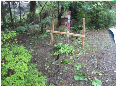
左の写真は平成 23 年台風 12 号 (連続雨量 494mm) で発生したクラックの写真です。
